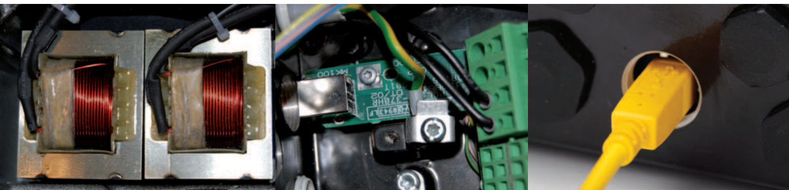
内置直流电抗器可抑制谐波失真。
